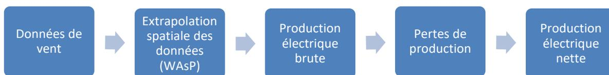
Le modèle WAsP permet d'extrapoler les données des stations météorologiques vers le site en tenant compte l'influence du relief, de la couverture de terrain et de la stabilité de l'atmosphère sur l'écoulement du vent.
